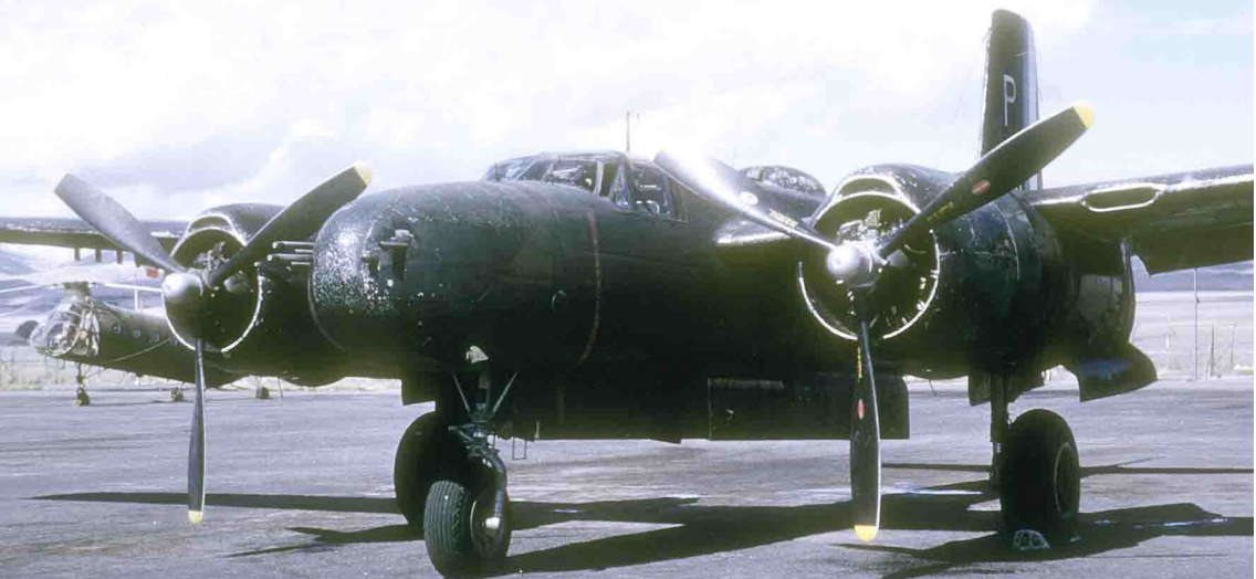
GB 1/91 Gascogne – Six mitrailleuses 12,7 mm du B-26B Straffer à Tébessa en 1959
